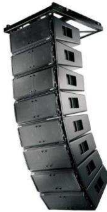
Figura 3. Immagine raffigurante una "Line Array" Questi sistemi di riproduzione sono costituiti da un certo numero di speciali moduli indipendenti (diffusori), sovrapposti verticalmente ed allineati, che operano come una singola sorgente sonora e che, se vengono rispettate alcune condizioni, sommano le loro emissioni in modo coerente (Fonte: SUVA [2]).
